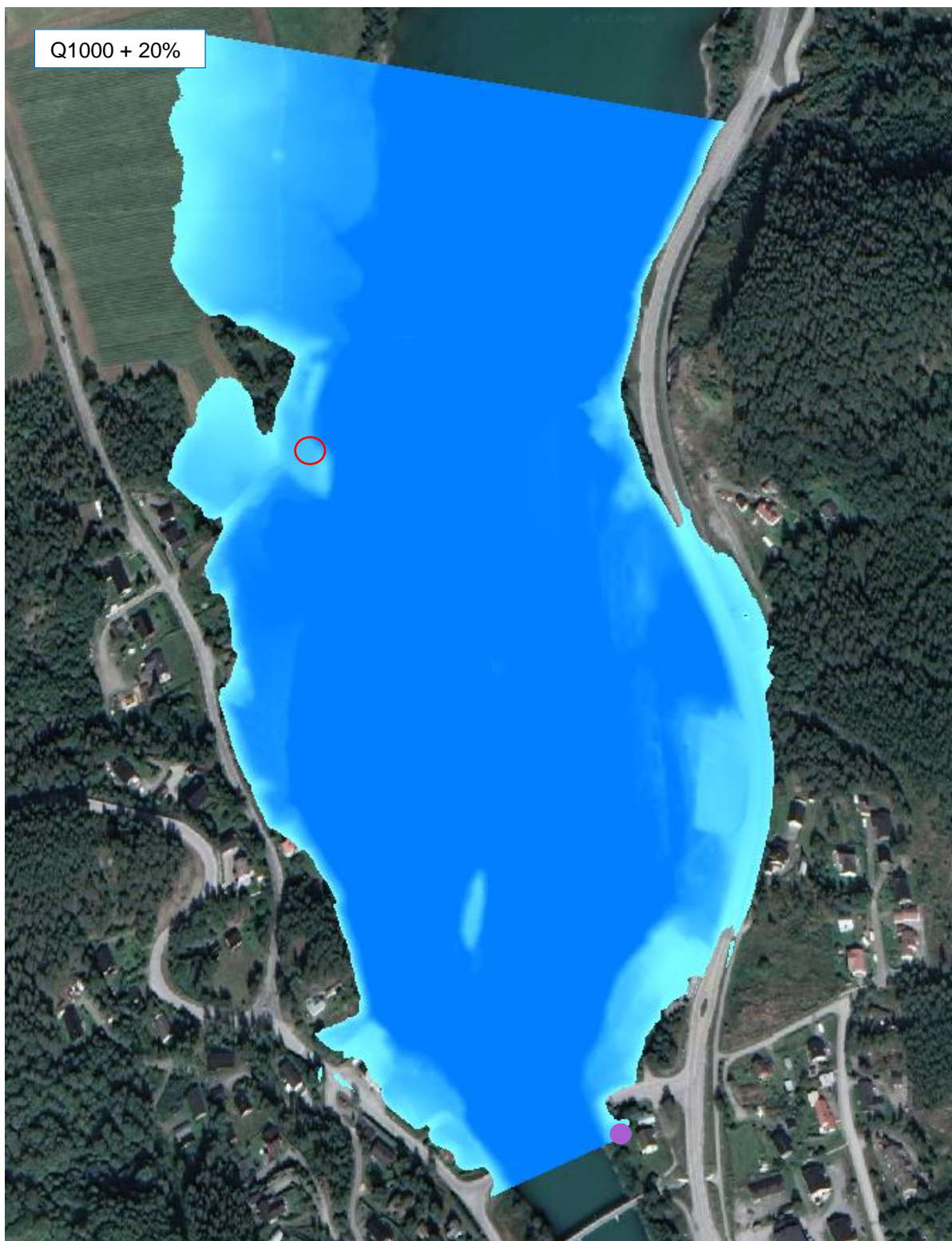
Figur 11: Elveløpets utstrekning ved en flom tilsvarende flom med 1000-års gjentaksintervall med 20 % klimapåslag (1793 m 3 /s). Lilla prikk tilsvarer plassering av målestasjonen på Lalm, mens rød sirkel viser Lalm vassverk.
